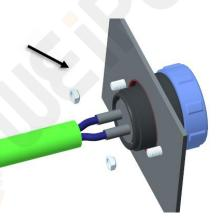
6、Screw locking torque: 0.1-0.15N.M
